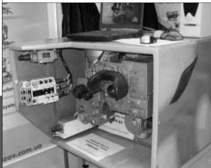
Для нового танка Т-84 «Оплот» ХКБМ создало рабочее место наводчика РМН 84, которое обеспечивает подготовку к стрельбе из пушки, спаренного и зенитного пулеметов с места и в движении, днем и ночью, при различных погодных условиях
